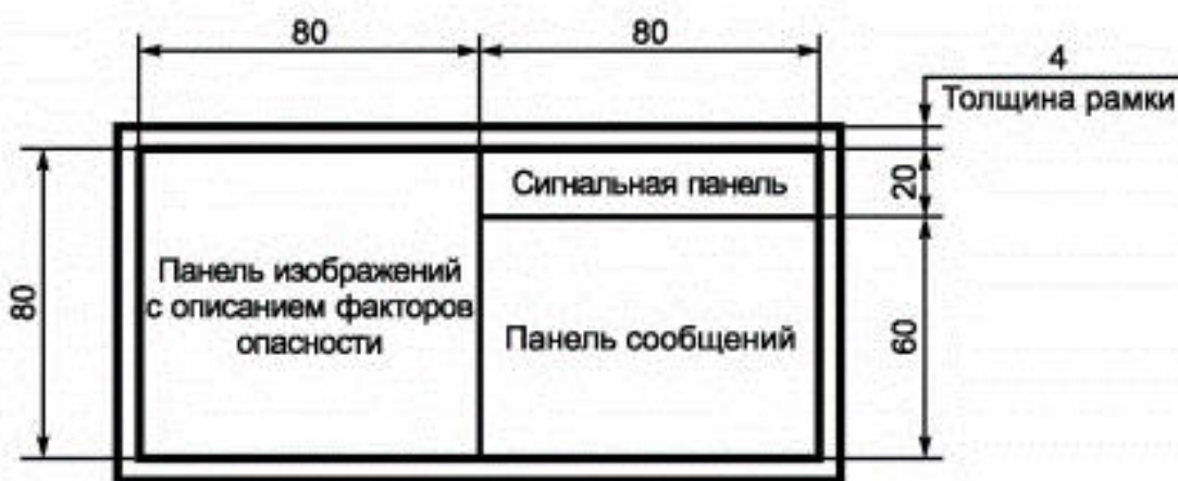
Рис.31 Пример трехпанельного знака безопасности горизонтальной конфигурации с рекомендуемыми размерами
